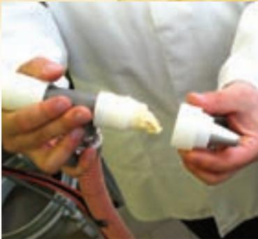
Der Wechsel der Vorsatzdüse wird über ein simples Gewinde vorgenommen. Für fast jede Anwendung sind passende Düsen erhältlich.
