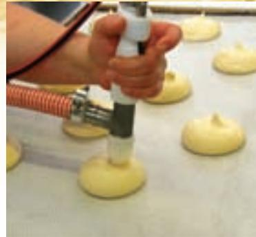
Der verstellbare Kolbenhub der Powerlift sorgt für die Gleichmäßigkeit und Gewichtsgenauigkeit der Produkte, wie hier bei Amerikanern.
