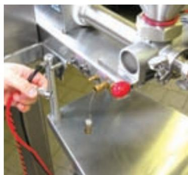
Da die Schnellkupplungen entweder männlich oder weiblich sind, kann beim Zusammenbau nichts verwechselt werden. Der rote Sicherheitsdraht am Trichter verhindert eine versehentliche Inbetriebnahme der Maschine, ohne diesen montiert zu haben.
