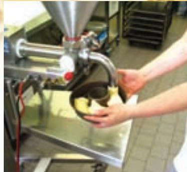
Über die direkt am Gerät anzubringende Winkeldüse lassen sich Formen mittels Betätigung des Fußschalters befüllen.
